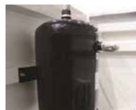
Наличие ресивера гарантирует надежность смены инструмента
