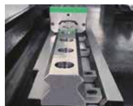
Направляющие качения с циркуляцией роликов шириной в 45 мм установлены по всем 3 осям
