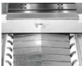
Телескопические кожуха по трем осям обеспечивают полный уровень защиты линейных направляющих и ШВП
